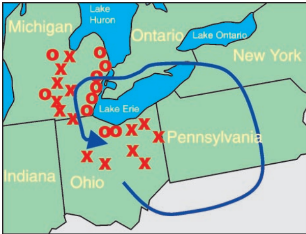
Rys. 1. Przepływy energii w chwili rozpoczęcia awarii [2] X — wyłączone linie przesyłowe, O — wyłączone elektrownie lub jednostki wytwórcze
