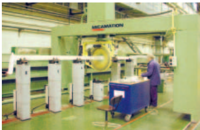
Rys.10. Automatyczna otaśmiarka do nakładania izolacji głównej pręta
