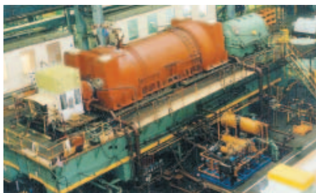
Rys. 24. Prototyp TOP GAS (500 MVA) na stanowisku testowym w trakcie prób typu
