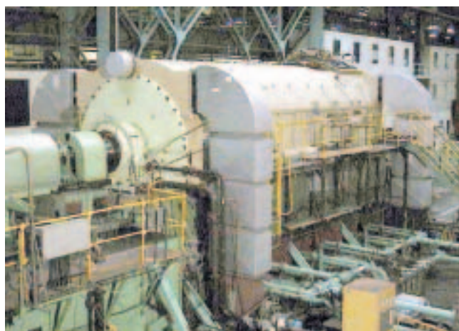
Rys. 23. Prototyp TOP AIR2 (480 MVA) na stanowisku testowym w trakcie prób typu
