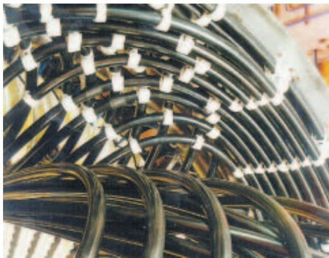
Rys. 16. Uzwojenie stojana transgeneratora – kable wysokonapięciowe zamiast tradycyjnych prętów
