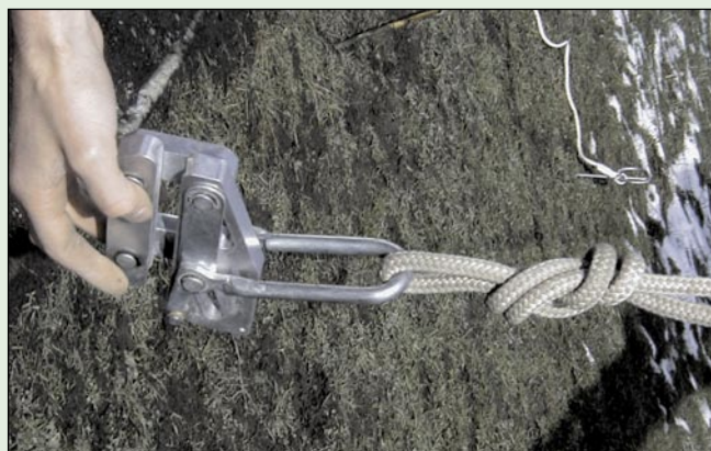
Pętla z ósemki zawiązana na urządzeniu do podtrzymywania przewodów
