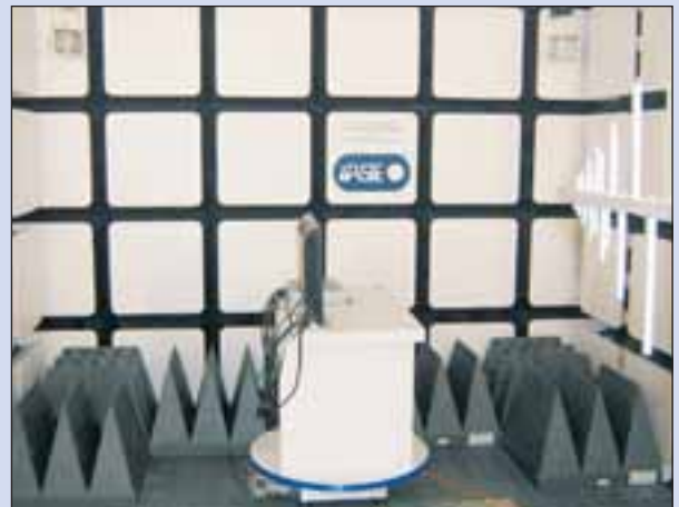
Rys. 2. Przykład stanowiska pomiarowego do badań wstępnych emisji zaburzeń elektromagnetycznych w komorze semi-bezodbiwoowej
