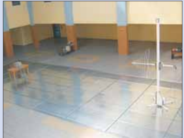
Rys. 1. Widok ogólny otwartego poligonu pomiarowego (OATS), zorganizowanego w hali wystawienniczej Instytutu
