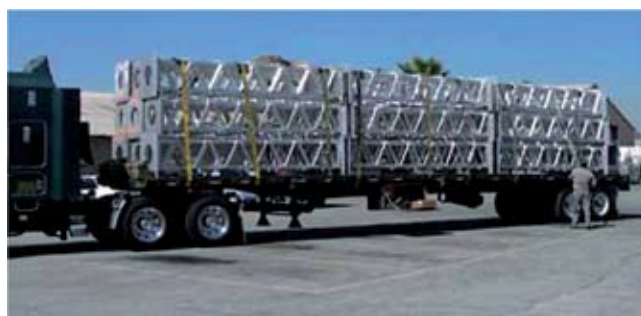
Rys. 5. Składowanie w kontenerach i transport tymczasowych konstrukcji [8], [10]
