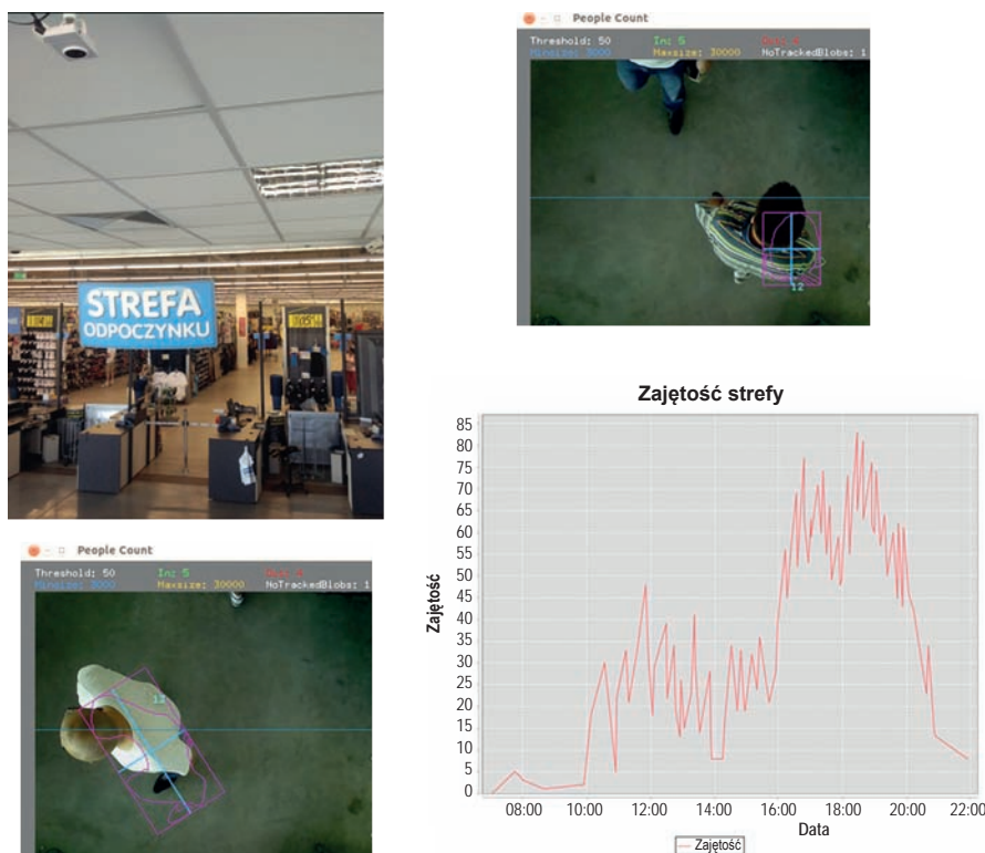
Rys. 2. Działanie bramek wideo mierzących zajętość strefy. Źródło [17]
