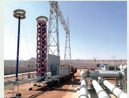
Rys. 5. Mobilny generator impulsowy 2400 kV [17]
