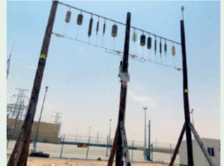
Rys. 7. Stacja pilotażowa do testów zabrudzeniowych izolatorów w Zatoce Perskiej a) rozmieszczenie i kształty izolatorów, b) widok stacji [33]
