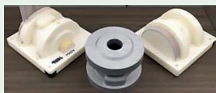
Rys. 19. Elementy wyłącznika wykonane metodą wydruku 3D
