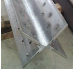
Rys. 27. Kątowniki „L” połączone spawem (po lewej), zdjęcia nowej konstrukcji słupów (po prawej)
