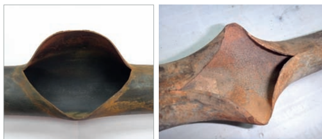
Rys. 8. Zaktócenia cyrkulacji czynnika w kotle – przegrzanie rur przegrzewacza pary Źródło: opracowanie własne
