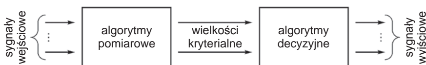
Rys. 1. Uproszczona struktura bloków funkcyjnych zabezpieczenia zerowoprądowego kierunkowego
