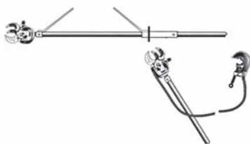
Rys. 6. Zastosowanie przenośnych iskierników ochronnych PPAG wg [8]
