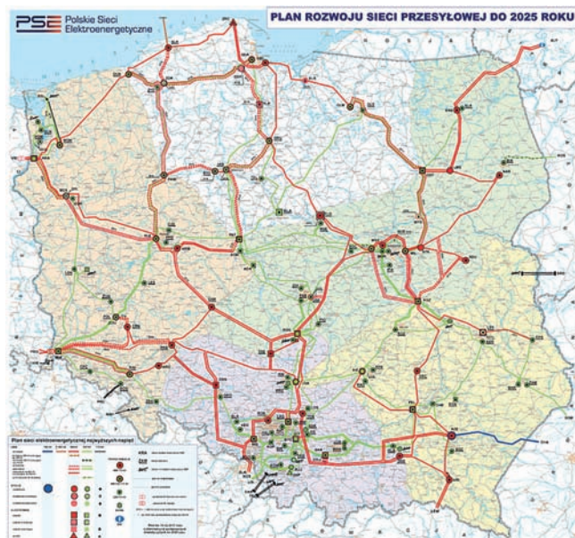
Rys.1. Lokalizacja istniejących oraz planowanych linii przesyłowych NN na obszarze Polski – 400 kV w kolorze czerwonym, 220 kV w kolorze zielonym
