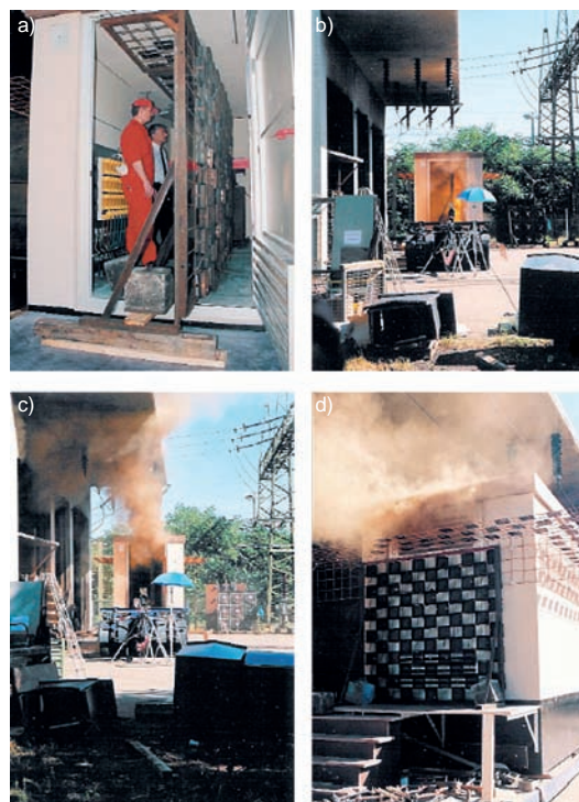
Rys. 4. Próba bezpieczeństwa obsługi a), b), c) oraz osób postronnych d), przy zwarciu łukowym w kontenerowej stacji z korytarzem dla obsługi [33- 37, 39]
