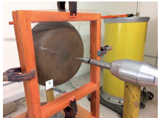
Rys. 1. Układ ostrze- płyta z poprzeczną przegrodą w postaci elektretu
