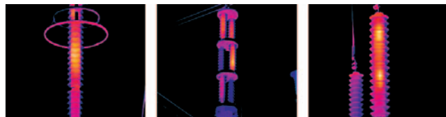
Rys. 2. Ograniczniki przepięć w izolacji kompozytowej na napięciach: a) 220 kV, b) i c) 110 kV
