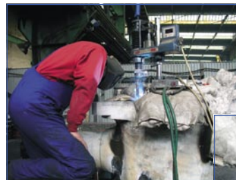
Rys. 15. Napawanie otworów korpusu zaworu szybkozamykającego WP turbiny 13K215
