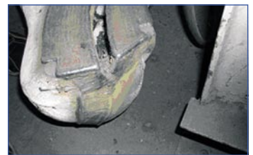
Rys. 14. Widok skrzyni po napawaniu i zespoleniu rozerwanych części
