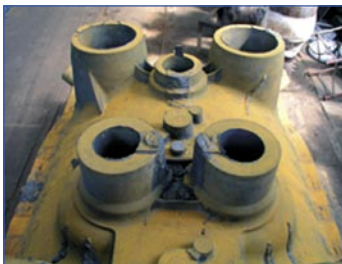
Rys. 2. Widok korpusu zewnętrznego WP turbiny 600 MW po częściowym usunięciu żeber
