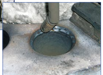
Rys. 15. Napawanie otworów korpusu zaworu szybkozamykającego WP turbiny 13K215
