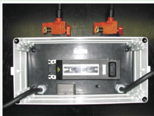
Rys. 16. Bocznik jednofazowy z rozłącznikiem na prądy 200–350A
