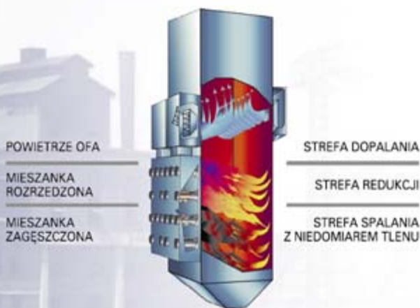
Rys. 2. Rozkład stref spalania w komorze paleniskowej kotła OP-650k w Elektrowni „Łaziska”
