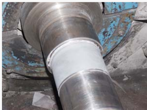
Rys. 2. Regeneracja wybitego czopa wału wentylatora podmuchu kompozytem Belzona®(1111)
