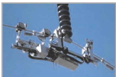
Rys. 10. Pokonywanie przeszkody przez robota w technologii LineScout na linii pod napięciem 315 kV [7]
