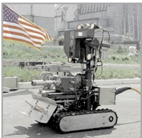
Rys. 2. Robot Pioneer zastosowany do usuwania skutków awarii w elektrowni atomowej w Czarnobylu [21]
