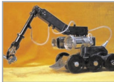
Rys. 3. Chiński robot do podwodnej inspekcji prętów paliwowych reaktorów atomowych [24]
