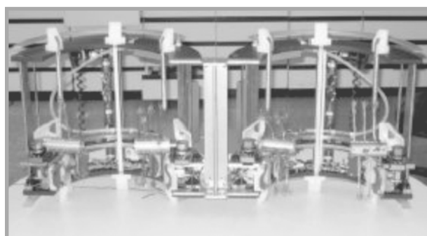
Rys. 11. Robot INCREO do czyszczenia izolatorów na sucho [9]
