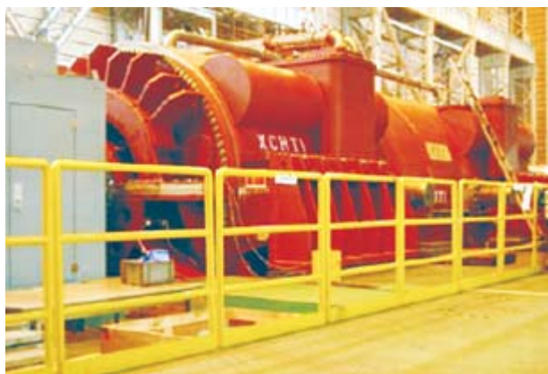
Rys. 6. Turbogenerator firmy Toshiba w czasie testów fabrycznych
