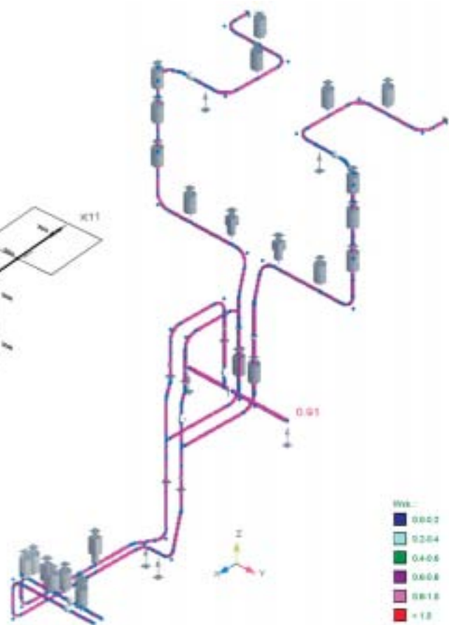
Rys. 6. Stosunek naprężeń zredukowanych do naprężeń dopuszczalnych po modernizacji zamocowań [4]
