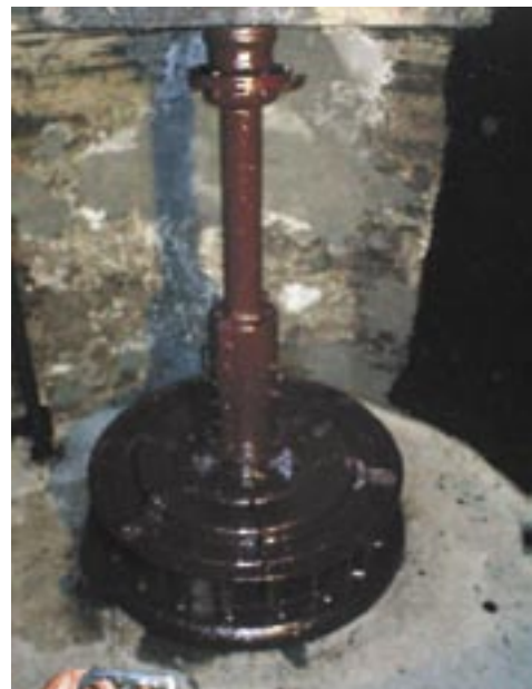
Rys. 3. Turbina typu Francis 110cm/170 z 1936 roku
