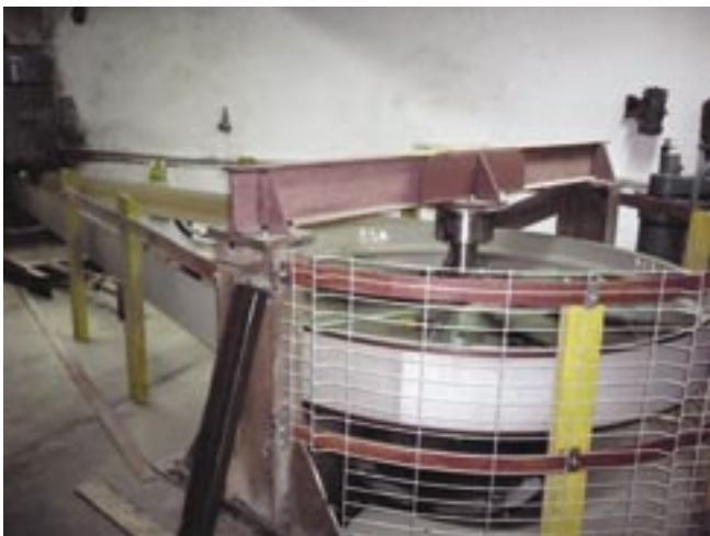
Rys. 8. Przekładnia pasowa po przebudowie
