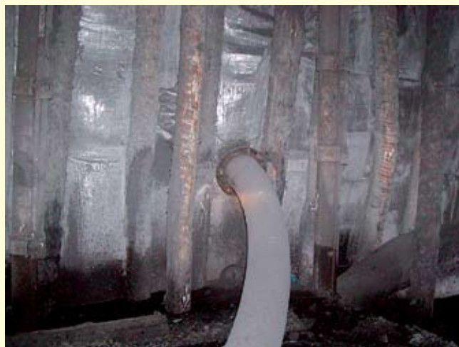
Rys. 4. Doszczelnianie zrobów zawałowych mieszaniną podsadzkową na bazie UPS (ZG Piekary)
