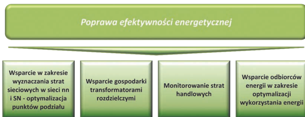
Rys. 4. Możliwość poprawy efektywności energetycznej przy wykorzystaniu systemu AMI
