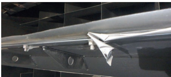
Rys. 6. Zniszczone uszczelnienia klap by-passowych wykryte w czasie inspekcji
