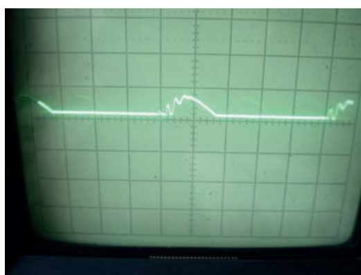
Rys. 17. Moc powrotna P_r spowodowana włączeniem indukcyjności dławika (kąta 50 stopni)
