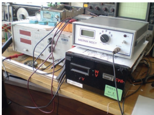
Rys. 19. Miernik mocy na stanowisku pomiarowym (zaciski pomiarowe napięciowe na rewersie przyrządu); w czarnej obudowie model synchronicznego miernika mocy i obok wzorcowy licznik energii elektrycznej
