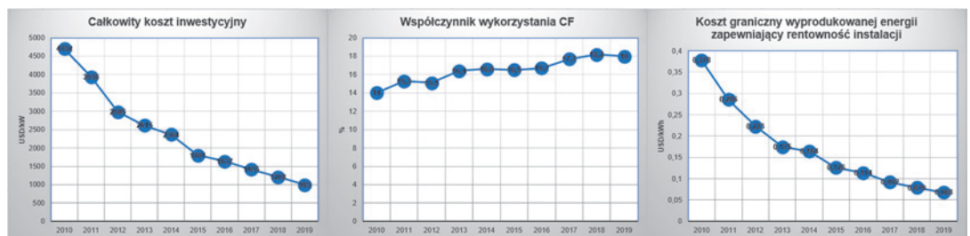
Rys. 4. Charakterystyki przedstawiające zmienność cen instalacji, współczynnika wykorzystania i kosztu granicznego wyprodukowanej energii zapewniającego rentowność instalacji PV Źródło: opracowanie własne na podstawie [11]
