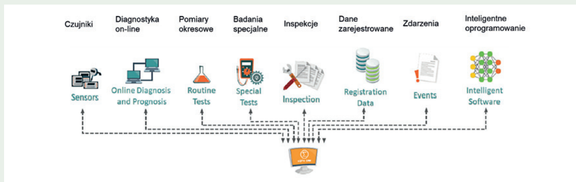
Rys. 8. Przykładowe informacje wykorzystywane do wyznaczenia indeksu stanu technicznego
